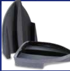
Prototipo de casco USV-Trimarán. 600 x 900 mm. *Imprimida por CEU (Universidad Cardenal Herrera)
