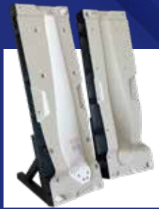
Molde para pala de aerogenerador. 1700 x 520 x 330 mm. *Imprimida por BTU (Universidad Tecnológica de Brandeburgo Cottbus-Serftenberg).
