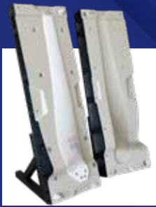
Molde para pala de aerogenerador. 1700 x 520 x 330 mm. *Imprimida por BTU (Universidad Tecnológica de Brandeburgo Cottbus-Serftenberg).
